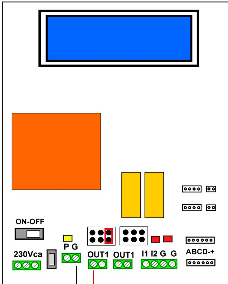
Cas de commande directe de la ventouse magnétique par la centrale TEXAS-XM avec fourniture du 12V par la centrale.
